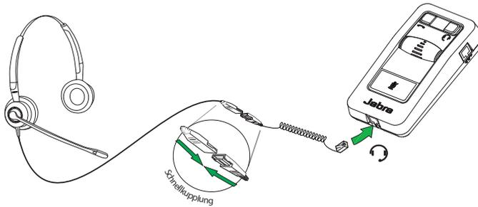
Wird das Headset vom Typ QD während eines Anrufs abgezogen, wird der Anruf gehalten. Wenn das QD wieder angeschlossen wird, wird das Gespräch fortgesetzt.
